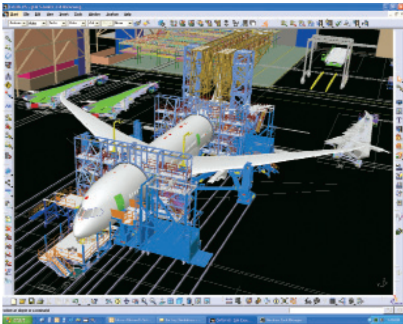
基于模型定义的波音787对接总装仿真
